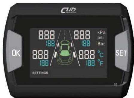
In Modalità Impostazioni, premere il botton SET; le funzioni disponibili sono le seguenti in sequenza: unità di pressione, unità di temperatura, valore limite pressione bassa, valore limite pressione alta, valore limite temperatura alta.
