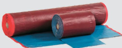
Rotolo in gomma legante autovulcanizzante per ricostruire o rivestire rappezi Tip Top radiali e diagonali. Da utilizzare in combinazione con Special Cement BL o Special Cement OTR. Tempo di attesa prima di poter utilizzare il pneumatico, in caso di vulcanizzazione a freddo, 48 ore (se il processo è avvenuto a una temperatura minimo di 18°).
